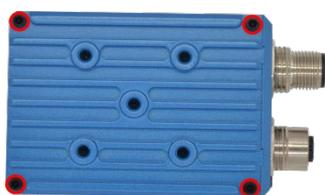
2. 使用 M1.5 的内六角螺丝刀逆时针拧下底部的 4 颗螺丝，如下图红色标记的位置。
