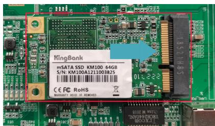
3. 插入固定SSD的螺钉，顺时针拧紧将SSD固定。
