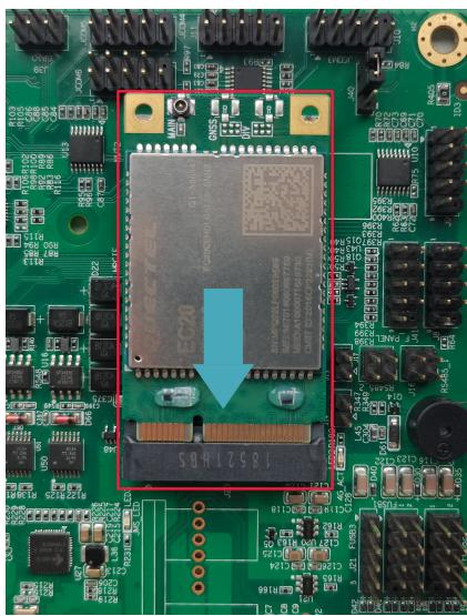
9. 插入2颗安装螺钉，顺时针拧紧，将4G模块固定。
