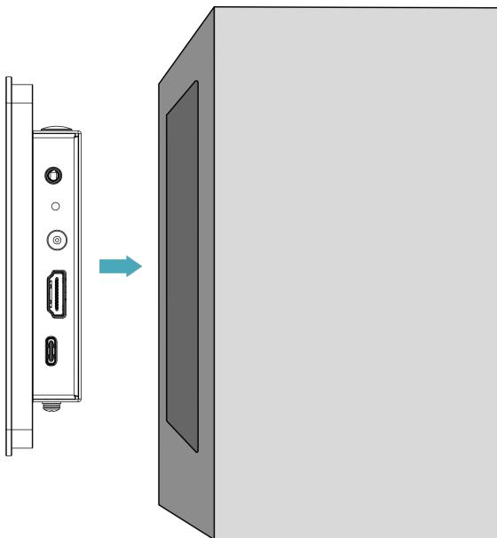
4. 将卡扣的螺丝孔（不带螺纹的孔）对准设备侧的卡扣安装孔。
