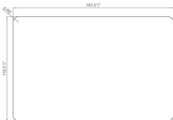
2. 根据步骤 1 的孔径大小在机柜上钻孔。
