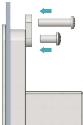
5. 使用4颗M4\*10螺钉穿过卡扣顺时针拧紧，将卡扣固定至设备上；再使用4颗M4\*16螺钉穿过卡扣的螺丝孔（带螺纹的孔）顶住机柜内侧顺时针拧到底。
