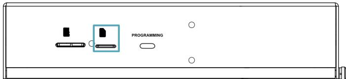
3. 将Nano SIM卡芯片端朝上插入对应的卡槽，听到一声响表示安装完成。
