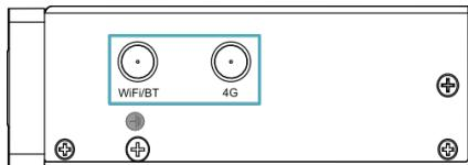
2. 对准设备和天线两侧的接口，沿顺时针方向拧紧，确保不会脱落即可。
