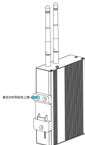
2. 向下按压导轨支架下侧的卡扣，直到支架可以扣在DIN导轨上，即安装完成。
