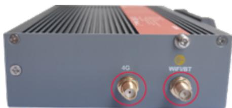
2. 对准设备和天线两侧的接口，沿顺时针方向拧紧，确保不会脱落即可。
