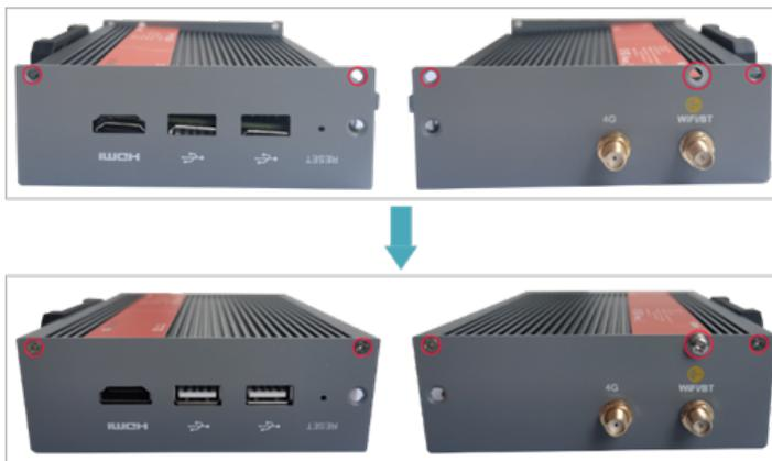
3. 使PCBA上的接口对准前面板的接口位置，插入前盖板，再使用螺丝刀顺时针拧紧2颗M3螺钉，如下图所示。
