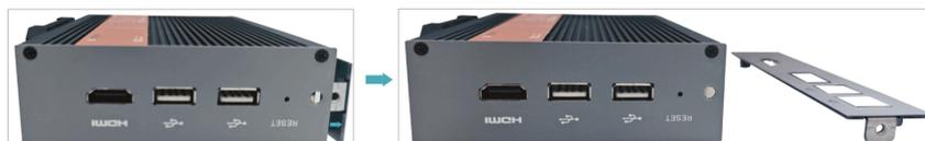
4. 使用螺丝刀逆时针拧下2个侧面的4颗M2.5螺钉和1颗接地螺钉，如下图红色标记处。
