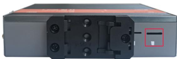
2. 将Micro SD卡正面朝下插入对应的卡槽，听到一声响表示安装完成。
