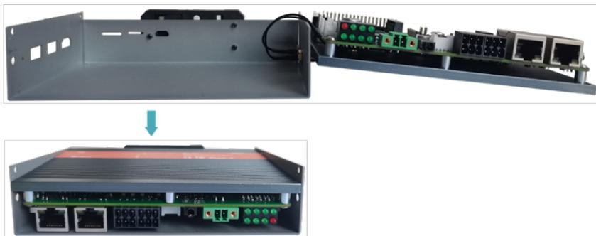
2. 对准上盖板和侧盖板的螺丝孔位，使用螺丝刀顺时针拧紧2个侧面的4颗M2.5螺钉和1颗接地螺钉，如下图所示。
