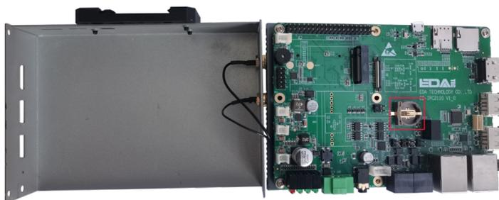
2. 将电池正极朝上，按压装进RTC底座中，安装完成的效果如下图。
