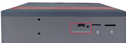
3. 连接好电源线和USB烧录线（Micro-USB转USB-A）。
