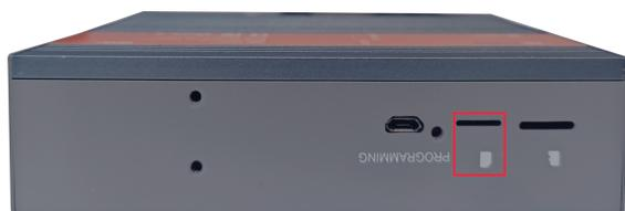
3. 将Nano SIM卡芯片端朝上插入对应的卡槽，听到一声响表示安装完成。
