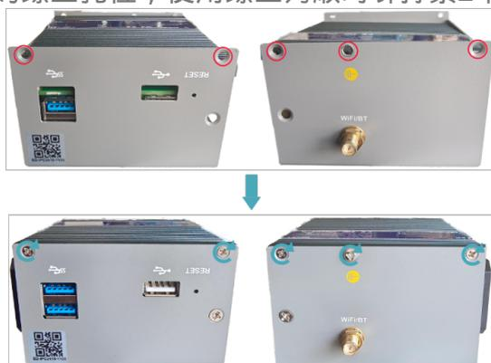
3. 使PCBA上的接口对准前面板的接口位置，插入前盖板，再使用螺丝刀顺时针拧紧2颗M3螺钉，如下图所示。
