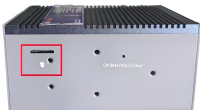
3. 将Micro SD卡正面朝下插入对应的卡槽，听到一声响表示安装完成。
