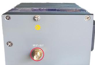
2. 对准设备和天线两侧的接口，沿顺时针方向拧紧，确保不会脱落即可。
