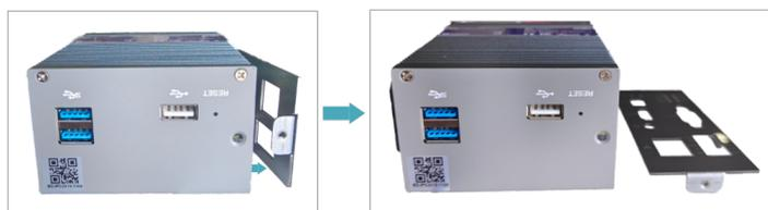
4. 使用螺丝刀逆时针拧下2个侧面的4颗M2.5螺钉和1颗接地螺钉，如下图所示。
