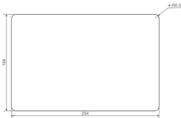
2. 参照开孔尺寸在机柜上开一个孔。
