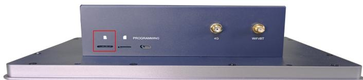
2. 将Micro SD卡触点面朝下插入对应的卡槽，听到一声响表示安装完成。
