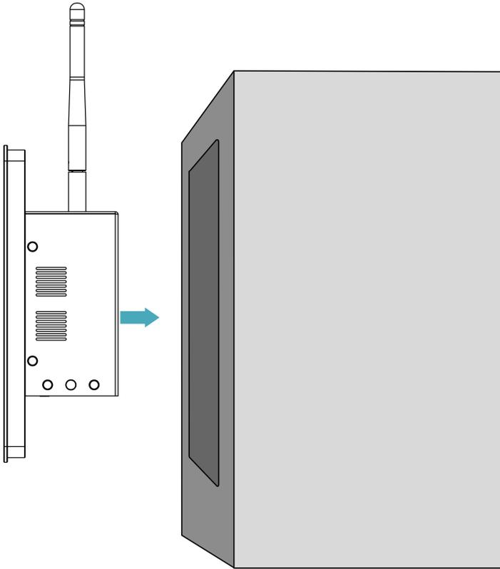
4. 将卡扣的螺丝孔（不带螺纹的孔）对准设备侧的卡扣安装孔。
