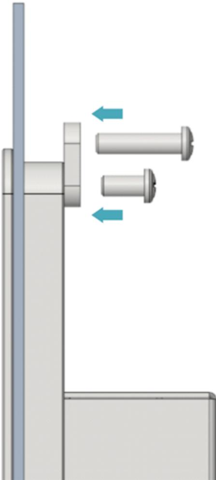
5. 使用4颗M4\*10螺钉穿过卡扣顺时针拧紧，将卡扣固定至设备上；再使用4颗M4\*16螺钉穿过卡扣的螺丝孔（带螺纹的孔）顶住机柜内侧顺时针拧到底。
