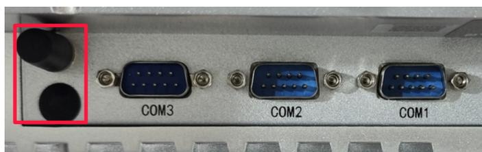
2. 对准设备和天线两侧的接口，沿顺时针方向拧紧，确保不会脱落即可。
