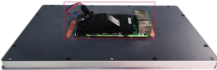
8. 插入 3 颗 M2.5\*12 螺钉和1颗M2.5\*5螺钉，顺时针拧紧，将 Raspberry Pi 4和ED-Pi4PCOOLER 固定在 LCD 屏的背面。
