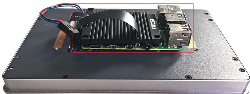
8. 插入 3 颗 M2.5\*12 螺钉和1颗M2.5\*5螺钉，顺时针拧紧，将 Raspberry Pi 4和ED-Pi4PCOOLER 固定在 LCD 屏的背面。
