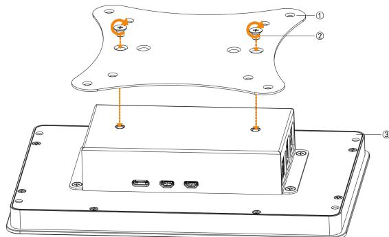
2. 转接板安装完成后，ED-HMI3010-101C设备将兼容75mm间距或者100mm间距的标准VESA支架的安装。
