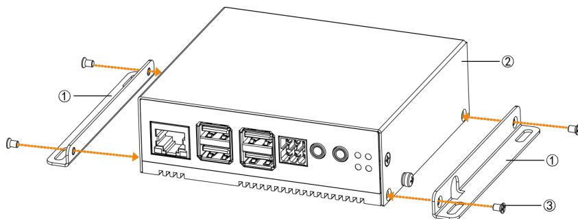
3. 根据下图ED-ACCBKT-L3020的左右支架的壁挂螺丝孔的距离和孔径，在墙上打孔后将设备进行壁挂安装。
