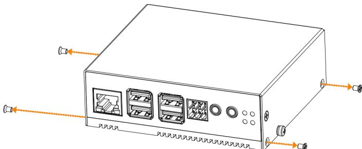
2. 将ED-ACCBKT-L3020的左右支架分别对准ED-IPC3020或ED-PAC3020的两个侧面的螺丝孔位，再插入4颗M2.5\*6的螺钉，使用十字螺钉刀顺时针拧紧，将ED-ACCBKT-L3020固定在ED-IPC3020或ED-PAC3020的侧面。
