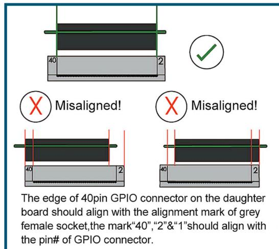
3. 在接通Pi 400的电源之前, 请根据下图仔细检查扩展模块的方向以及针脚1,2和40的位置。
